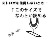
②回転している文字が同じ場所にタイミングよくくるようにストロボが光る間隔を調節する。
